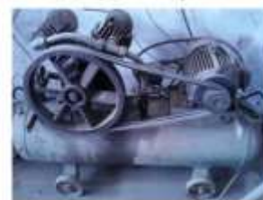
空气压缩机 air compressor
